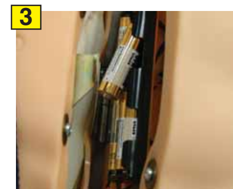
3 Извлечь использованные элементы питания из контейнера и, соблюдая полярность, вставить новые
